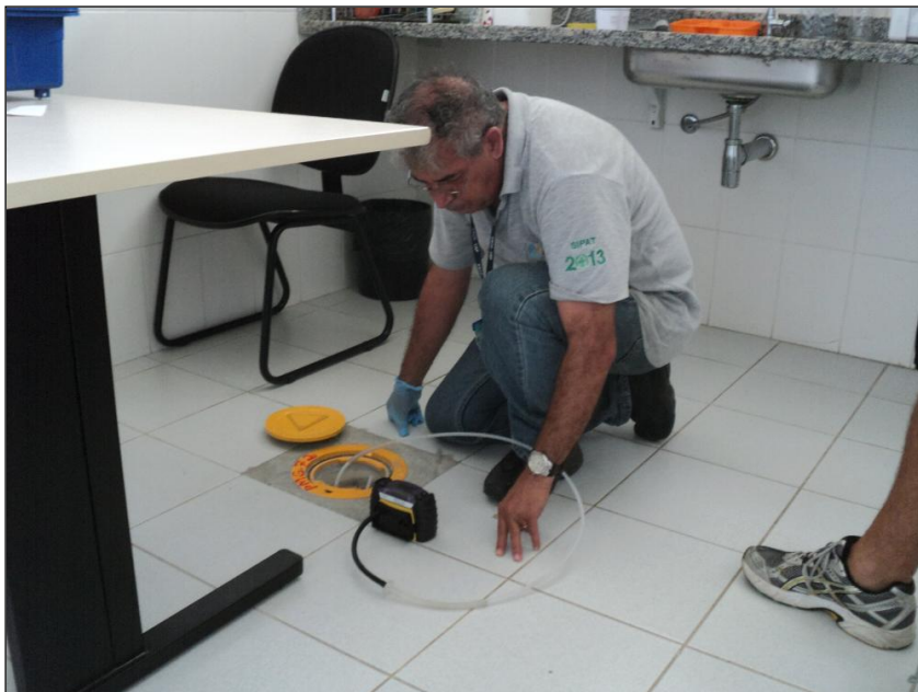
Foto nº 10 - Medições no Prédio de Enfermagem no PM 72 A/B com presença nula de metano (horário - 13:40 h) :
