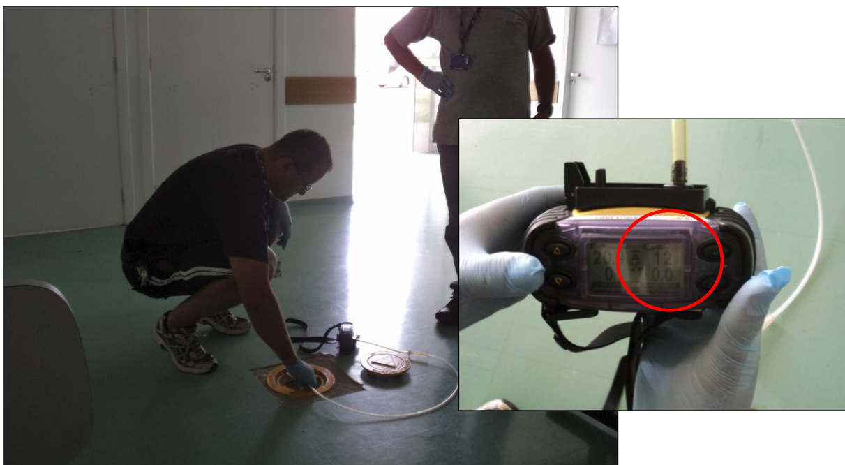
Foto nº 11 - Medições no Prédio de Enfermagem no PM 74 A/B detectando concentração de 12 %V/V de metano (PM 74 B), superior ao LII (horário - 13:50 h):
