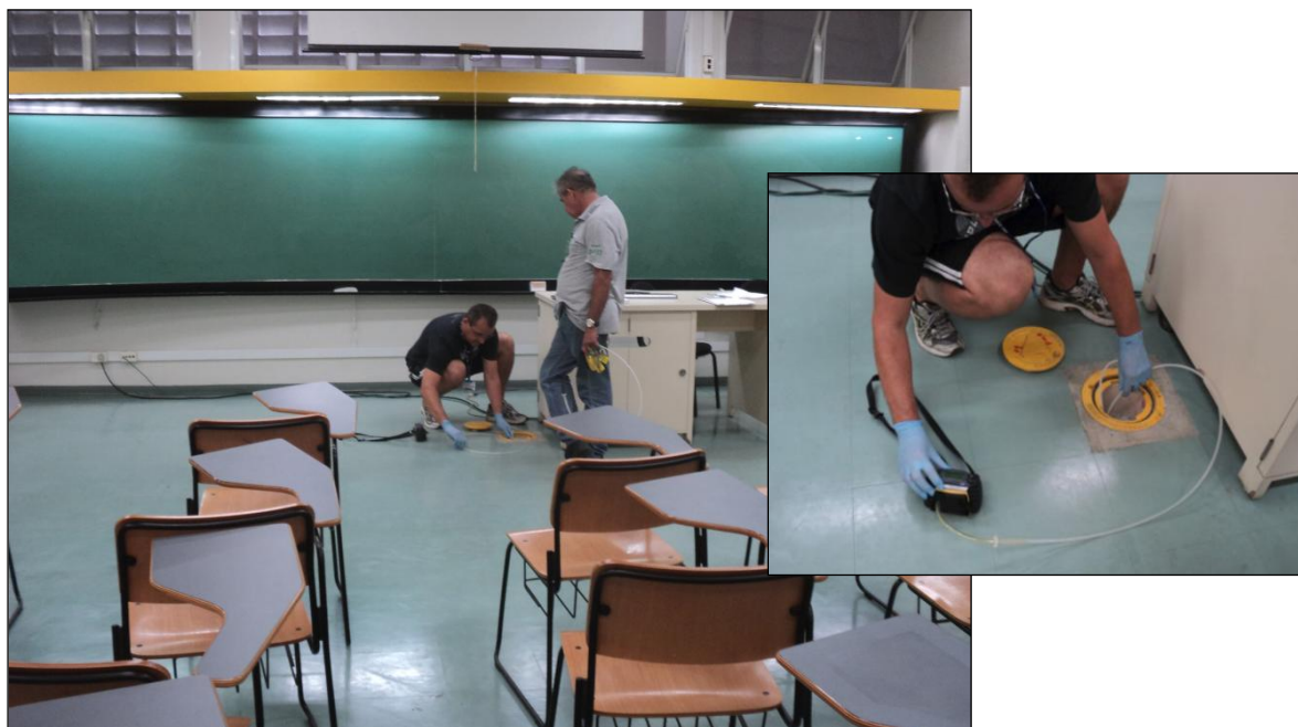
Foto nº 13 - Medições no Prédio do Ciclo Básico, com presença nula de metano no PM 01 A/B (horário - 14:20 h):
